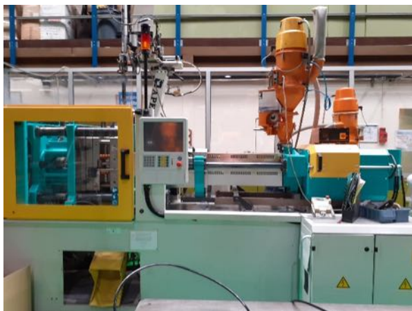
Wtryskarka plastiku: obudowa, nasadka, zaślepka
